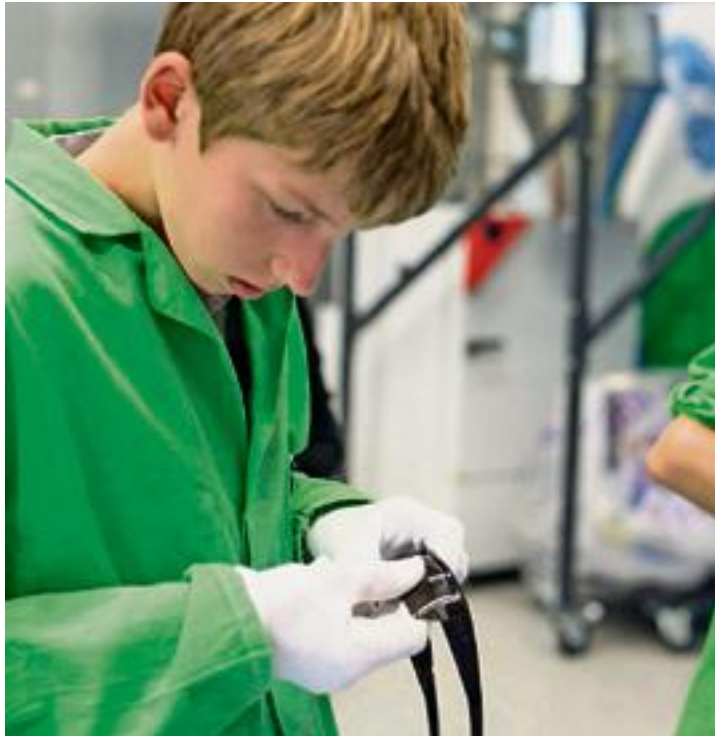
Der letzte Schritt: Einsetzen der Gläser in das Brillengestell.
